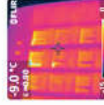
Здание с низкой энергоэффективностью (стены в два кирпича)
